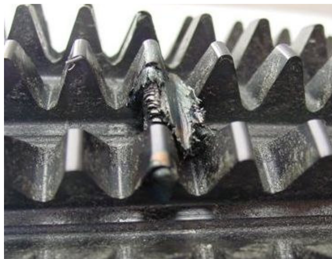
Figura N°3- Intasamento dei trucioli durante il taglio a secco
