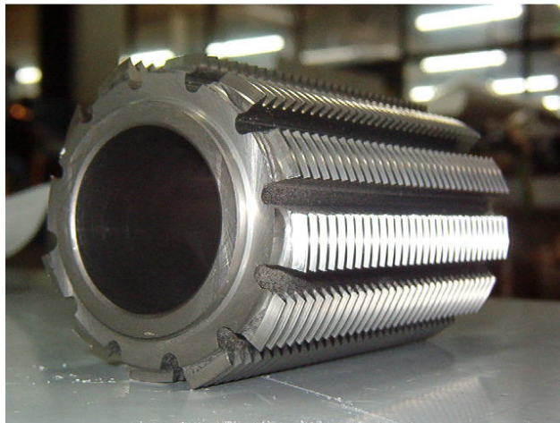
Figura N°1- Creatore ricoperto in TiAlN per il taglio a secco
