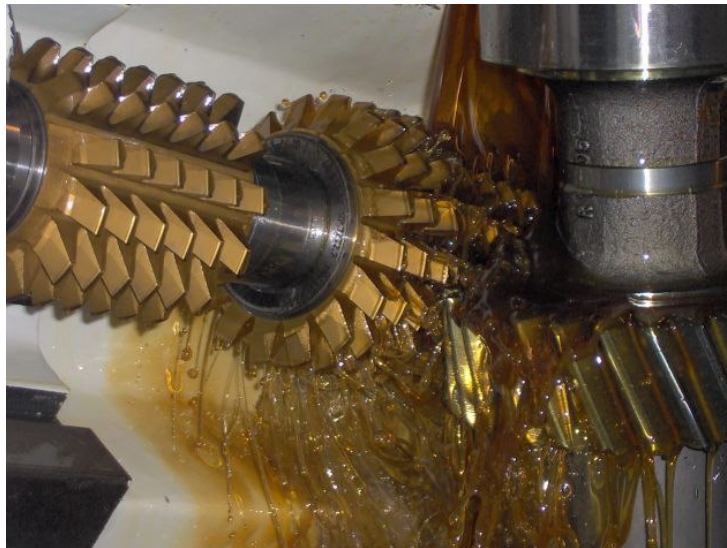
Figura N°1 - Dentatura di due ingranaggi con un creatore doppio.
