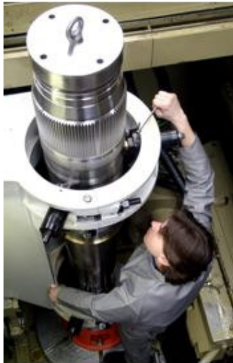
Figura N°4- Main Shaft di elicottero ( Flight Safety Part ) in fase di montaggio sulla dentatrice a creatore.
