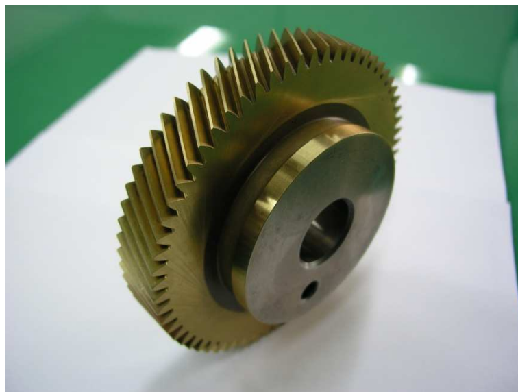
Figura N°4 - Master per ingranaggio cilindrico elicoidale ricoperto con TiN
