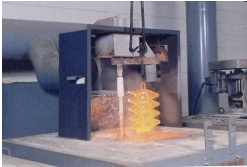
Figura N°1 – Trattamento di tempra di un creatore
