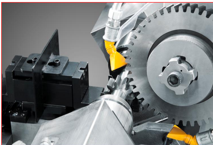
Fig. N°4 – Rasatura di un ingranaggio del settore automotive con rasatrice Sicmat RASO -200 Dynamic
