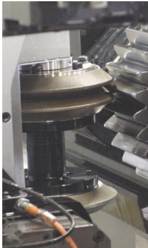
Figura N°11- Esempio di rettifica di un ingranaggio con mole di forma in CBN
