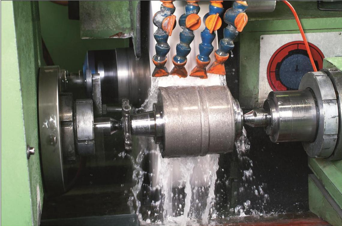
**Figura N°3** – *Operazione di ravvivatura con un rullo diamantato*
