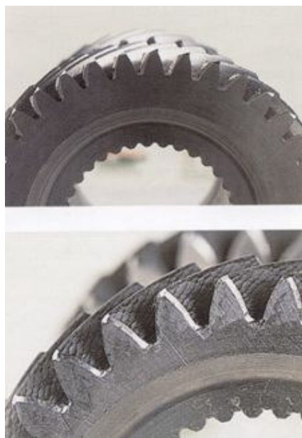
Figura N°1- Dentatura prima e dopo le operazioni di smussatura - sbavatura
