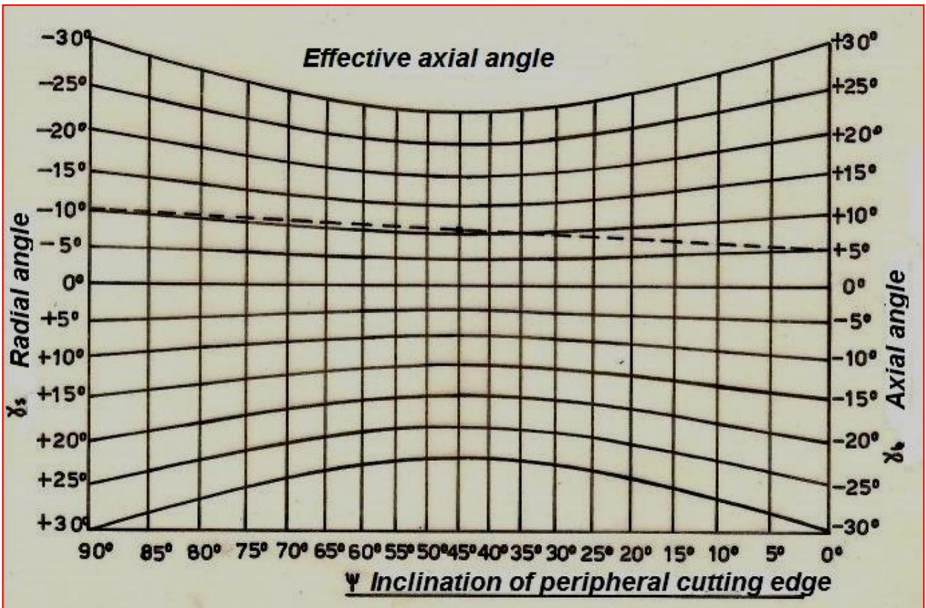
Fig. N°6- Effective axial rake angle
