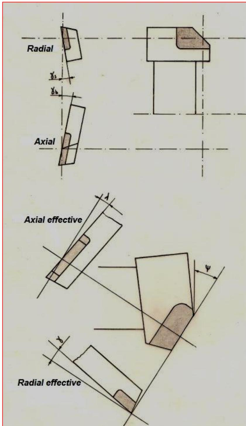
Fig. N°4- Effective rake angles
